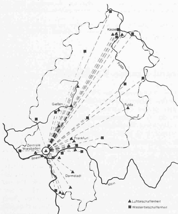
Entwurf eines Fernüberwachungsnetzes für den Umweltschutz im Lande Hessen. Erfassung von Luft- und Wasserbeschaffenheit (links), und von Niederschlägen und Wasserständen von oberirdischen Gewässern (rechts); Datenübertragung von den Messstationen zur Zentrale über das öffentliche Fernsprechnetz
