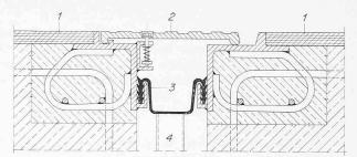
Bild 31. Fugenübergang für Gehweg mit Schlepplatte und Entwässerungsrinne
