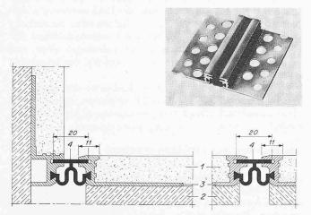
Bild 23. Fugenabdichtungsprofil für verputzte Flächen, bzw. Bodenbeläge
