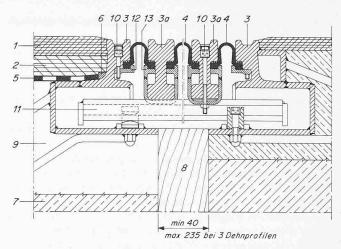
Bild 17. Fahrbahn-Übergangskonstruktion für sehr grossen Dehnweg mit zwei Mittellamellen. Zahlenlegende siehe Bild 16
