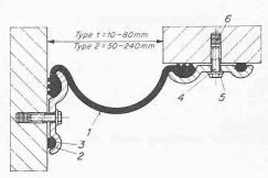
Bild 30. Wasserdichter Abschluss einer Fuge zwischen Wand und Decke, oben bzw. unten an der Decke angebracht. Der entstehenden Rinne kann durch das Anordnen der Befestigungen ein leichtes Gefälle gegeben werden. Zahlenlegende Bild 29
