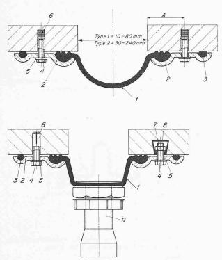
Bild 29. Auswechselbarer unterer Abschluss einer Fuge, die als Rinne ausgebildet ist. Unten der dazugehörende Vertikalablauf
