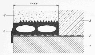
Bild 28. Konstruktive Ausgestaltung der Aussenwand bei einem Deckenauflager
