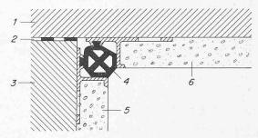
Bild 27. Anschlusskonstruktion Decke-Wand, innen
