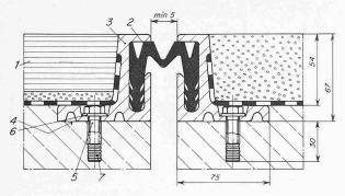
Bild 10. Übergangskonstruktion für Bodenbeläge
