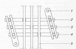
Bild 19. Synchronsteuerung für die Mittellamellen der Fahrbahn-Übergangskonstruktion
