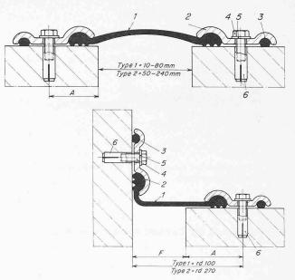
Bild 25. Wasserdichte Abdeckung von Fugenspalten
