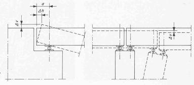
Bild 2. Schematische Darstellung von Brückenbewegungen. Links Durchbiegung, rechts Stützendrehung
