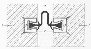
Bild 26. Fugenausbildung zwischen vorfabrizierten Elementen, für ein Fugenspiel von 5 bis 30 mm
