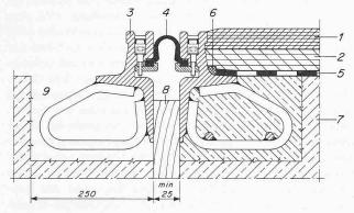
Bild 15. Fahrbahn-Übergangskonstruktion
