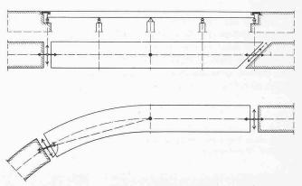
Bild 1. Schematische Darstellung der durch Fugenkonstruktionen aufzunehmenden Bewegungen
