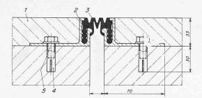
Bild 8. Übergangskonstruktion für Bodenbeläge
