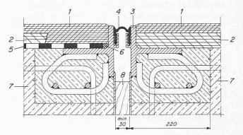
Bild 13. Fahrbahn- und Gehweg-Übergangskonstruktion
