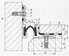
Bild 9. Übergangskonstruktion Bodenbelag-Wand (aufgehendes Mauerwerk oder Pfeiler)
