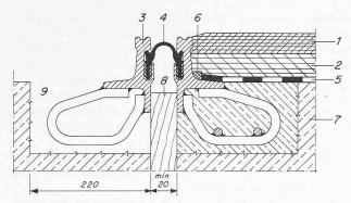
Bild 14. Fahrbahn- und Gehweg-Übergangskonstruktion
