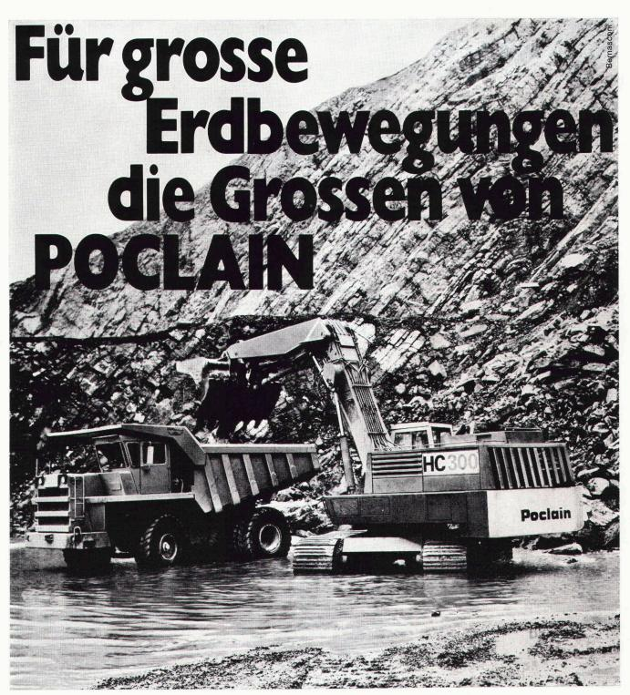
POCLAIN Hydrobagger Mod. HC 300 und WABCO Muldenkipper «Haulpak» mit 35 t Nutzlast
