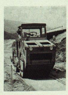
Die knickgelenkte Clark-Scheid-Doppelvibrationswalze DV 100
