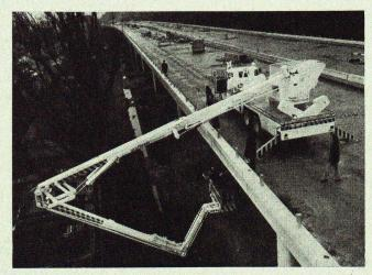
Dank der vierarmigen Gelenkkonstruktion ist das Brückenuntersichtsgerät äusserst beweglich. Die maximale Reichweite unter die Brücke beträgt 13,5 m, was der Breite einer zweispurigen Autobahn entspricht
