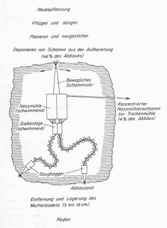
Bild 1. Arbeitsgänge beim Titanerzabbau (von unten nach oben)
