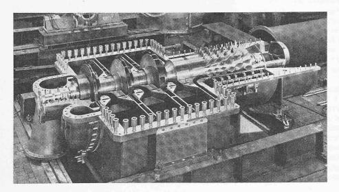
Bild 1. Neuer Isothermverdichter der Brown Boveri-Sulzer Turbomaschinen AG (BST), Fördermenge 140 000 bis 450 000 m³/h, Druckverhältnis 6 bis 11,5
