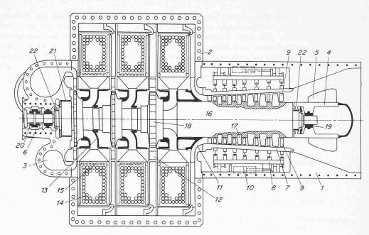
Bild 2. Horizontaler Längsschnitt durch den Isothermkompressor Typ ARI
