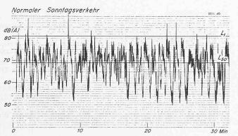
Bild 1. Lärmmessungen am Uto-Quai, Zürich. Zeitlicher Verlauf des Schallpegels bei Autobusverkehr
