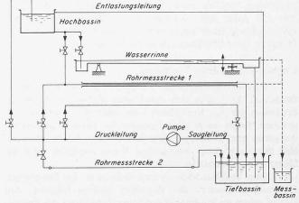
Bild 2. Schema des Hydraulik-Laborkreislaufes
