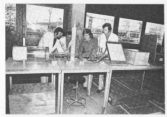
Bild 4. Labor für Hydraulik: Studenten messen am Air-Flow-Kit-Modell die Geschwindigkeitsverteilung und die sekündlich durch eine Plexiglasleitung strömende Luftmenge
