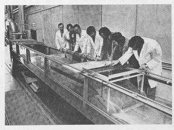
Darüber hinaus steht ein aeromechanisches Modell (Air-Flow-Kit) sowohl für qualitative Versuche zur Demonstration der aero- bzw. hydromechanischen Grundgesetze als auch zur quantitativen Bestimmung der Rauhigkeits- und Einzelverluste einer vom Medium Luft durchströmten Druckrohrleitung den Studenten beider genannter Abteilungen zur Verfügung (Bild 4).
