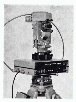
**Wild DI 3** Reduzierender IR-Tachymeter mit einer Reichweite bis etwa 900 m. Vollautomatische Distanzmessung und Anzeige von Horizontaldistanz und Höhenunterschied nach Eingabe des V-Winkels.
