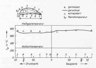
Bild 13. Vergleich der an einer Prototypmaschine gemessenen Temperaturverteilung mit den vorausberechneten Werten für das Leitschaufelsegment des Bildes 11
