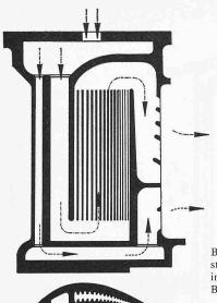
Bild 12. Schematische Darstellung der Kühlluftführung im Leitschaufelsegment des Bildes 11
