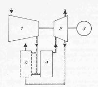
Bild 1 (links). Prinzipschema der Gasturbine nach dem offenen Prozess
