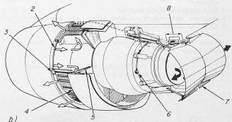
Bild 9. Einzelheiten der Schubumkehreinrichtung
