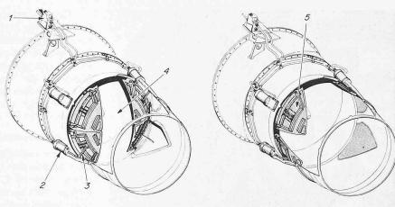
Moduln (Bild 12). Die meisten dieser Baugruppen können ausgewechselt werden, ohne das man das Triebwerk ausbauen muss. Mit dieser Bauart wird im Wartungsablauf der Übergang von den festen Zeiten zwischen den Überholungen auf ein zustandsbedingtes Programm vollzogen. Mit Hilfe von fest eingebauten Führungsschienen können die meisten Hauptbaugruppen in wenigen Stunden ausgetauscht werden.
