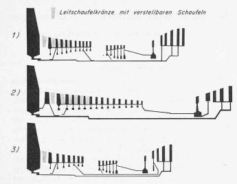
Bild 2. Schematische Darstellung der untersuchten Konstruktionsvarianten
