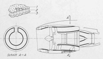
Bild 7. Anordnung der schallschluckenden Verschalungen beim Triebwerk RB. 211. Die Gesamtfläche beträgt 18,5 m². Links oben: Darstellung der wabenförmigen Konstruktion der Verschalung
