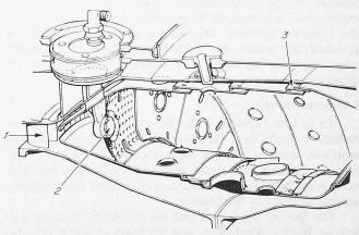
Bild 5. Schematische Schnittdarstellung der Ringbrennkammer
