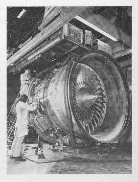
Bild 15 (rechts). Das Triebwerk RB. 211–24 wird für die Prüfstandversuche vorbereitet
