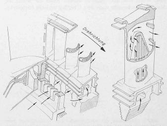
Bild 6. Kühlung der Hochdruckturbinenschaufeln. Links: Der Luftstrom wird durch Leitschaufeln beschleunigt und in die Drehrichtung der Turbine umgeleitet. Rechts: Die Kühlluft strömt mit hoher Ge-Geschwindigkeit im Schaufelinneren gegen die Eintrittskante (Prallkühlung) und tritt durch Schlitze an der Austrittskante hinaus
