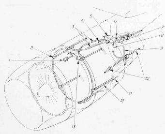
Bild 11. Schubumkehr- und Störklappenantrieb
