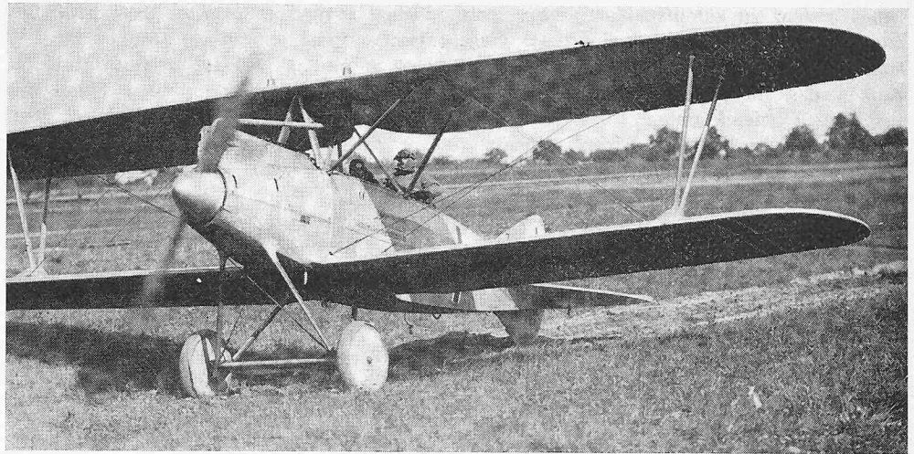
Bild 2. Metallflugzeug Zepp C II, Typ Jaray aus dem Jahre 1918
