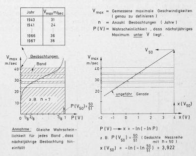
Bild 2. Bestimmung der maximalen Geschwindigkeit
