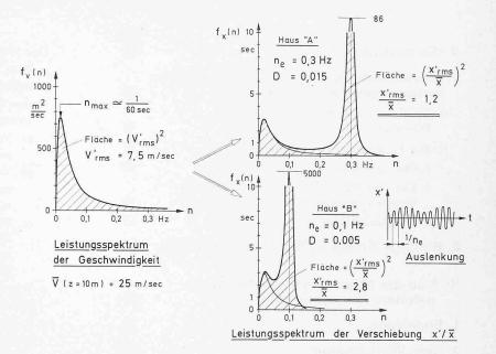
Haus «A»  $x'_{rms}/\bar{x} = 1,2$   $x_{max}/\bar{x} \cong 1 + 4 \cdot 1,2 = 5,8$  Haus «B»  $x'_{rms}/\bar{x} = 2,8$   $x_{max}/\bar{x} \cong 1 + 4 \cdot 2,8 = 12,2$
