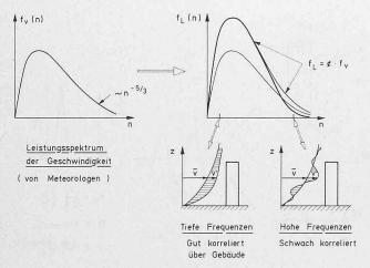
Bild 18. Lastschwankung aus Geschwindigkeitsschwankung
