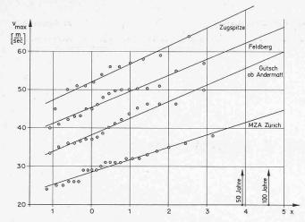
Bild 3. Maximale Geschwindigkeit an verschiedenen Orten
