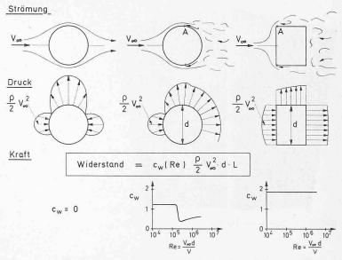
Bild 6. Umströmung von Körper, Druckverteilung, Kraft
