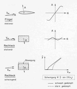
Bild 14. Energieaufnahme aus Strömung
