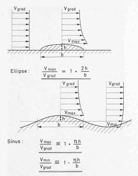
Bild 5. Einfluss von Geländeform auf Geschwindigkeit (reibungsfrei)
