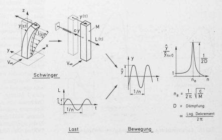
Bild 16. Einfacher Schwinger mit Sinus-Anregung
