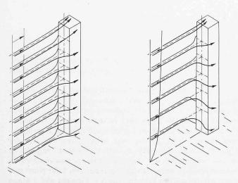
Bild 12. Übergeschwindigkeiten am Fusse eines Hochhauses
