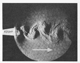
Bild 15. Kármán-Wirbel hinter einem stumpfen Körper
