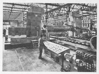
Bild 2. Bell-Rohrdrehbank zum Bearbeiten der beiden Rohrenden. Rohrinnendurchmesser 300 bis 2000 mm, Rohrlänge 4000 und 5000 mm, Spindeldrehzahl 12 bis 125 U/min (18stufig), Schnittgeschwindigkeit 100 bis 130 m/min, Stahlvorschub 0,01 bis 4,5 mm/Umdrehung, stufenlos regelbar
