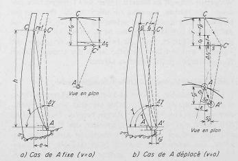
Figure 1. Dispositif de principe pour la mesure abrégée des déformations radiales r — Etude de l'erreur  $\triangle r_{\rm S}$  dans le cas où  $\nu$  est nul ou négligeable
