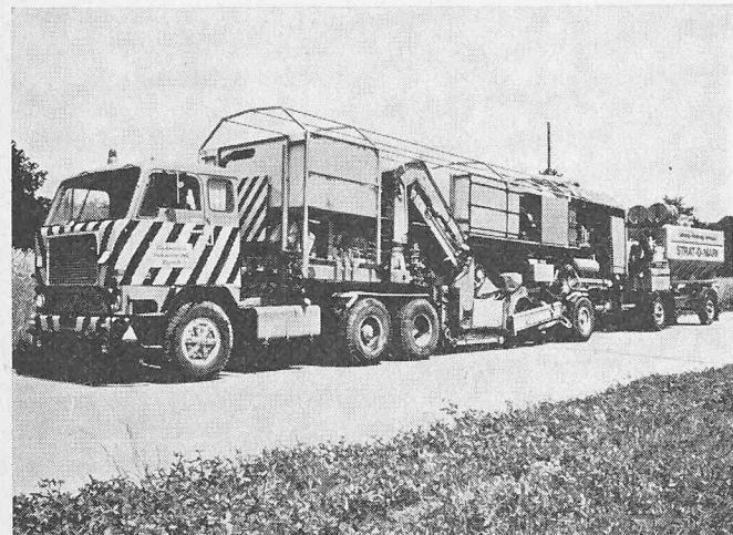
oder Betonbelag eine Nut geschliffen, wobei der Frästaub abgesaugt und im Anhänger gesammelt wird, was von der Bedienungsmannschaft besonders geschätzt wird. Hinter der Fräse wird die Heissplastikmasse in die schleifwarme Nut eingegossen und Reflexperlen nachgestreut. Die Markierungsstriche, welche 1 oder 2 cm in die Strassendecke eingelassen werden, können unmittelbar nach dem Verlegen überfahren werden. Dadurch ist die Verkehrsbehinderung auf ein Mindestmass beschränkt.
