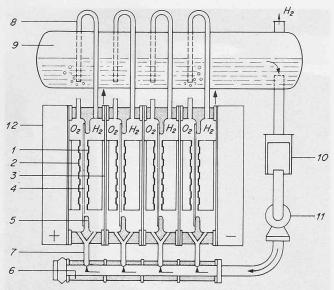
Bild 1. Schnitt durch einen Elektrolyseur
