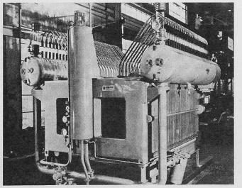
scher Sicherheitsverschluss geschaffen; gleichzeitig entsteht zwischen der Anoden- und der Kathodenseite jeder Zelle der erforderliche Druckausgleich.
