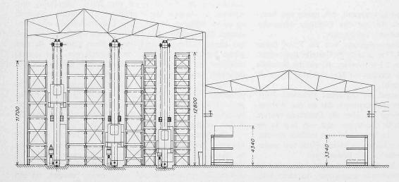
Bild 1. Schnitt 1:300 durch das Plattenlager. Links das Hochregallager, rechts der Trakt für die Kommissionierung an den die Speditionshalle anschliesst
