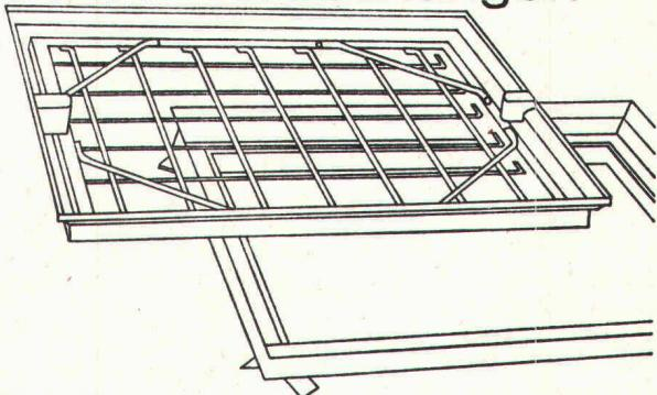
Für den Bauausführenden: Keine Probleme beim Einbau! Die Nenngrößen passen sich entweder den verschiedensten Plattenformaten von Fußbodenbelägen an oder weisen den Vorschriften entsprechende Mauermaße für die lichte Schachtweite auf.
