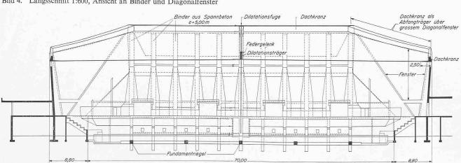
Bild 4. Längsschnitt 1:600, Ansicht an Binder und Diagonalfenster
