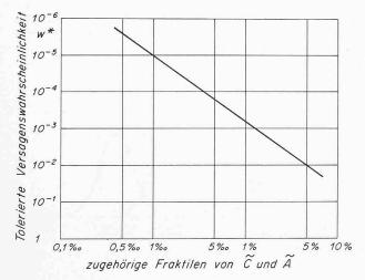
Bild 5. Zusammenhang zwischen tolerierter Versagenswahrscheinlichkeit  $w^*$  und den zugehörigen Fraktilen von  $\widetilde{C}$  und  $\widetilde{A}$
