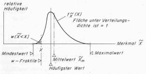
Bild 2. Verteilungsdichte einer stochastischen Grösse mit Wahrscheinlichkeit w für das Auftreten von Werten  $\widetilde{x} < x$
