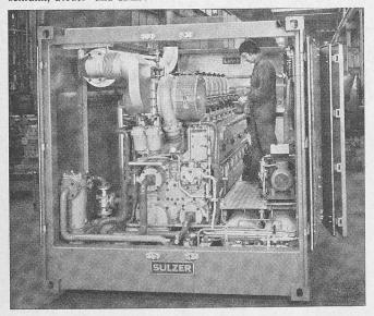
Glykol- bzw. mit Reinwasserkühlung. Sie kann direkt mit Steckkupplungen – an Stelle bisher üblicher Klemmverbindungen abgenommen werden. Die zulässige Überlast beträgt 10 % während 1 h, bezogen auf 12stündigen Normalbetrieb.
