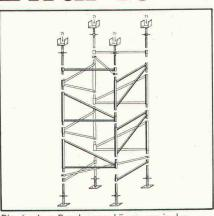
Die einzelnen Bauelemente können nur in der richtigen Reihenfolge zusammengesteckt werden. Eine Fehlmontage ist ausgeschlossen.
