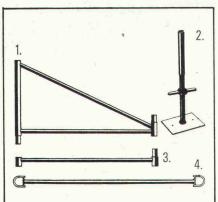
Ein ETEM-Turm besteht aus vier Bauelementen, die ohne Werkzeug zusammengefügt werden können: 1. Rahmen, 2. Fuss- bzw. Kopfspindel, 3. Endstrebe, 4. Horizontal-Diagonale. Das schwerste Element wiegt bloss 10,5 kg.
