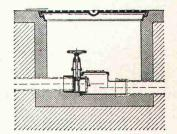
Rückstaudoppelverschluss TRIPLEX für durchgehende Leitungen
