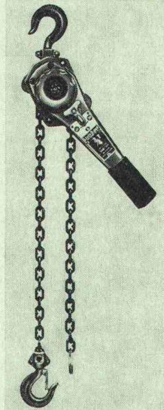
Ein neuartiger Kettenfreilauf erlaubt rasches Einrichten des Gerätes. Durch Drehen des Handrades wird eine straffe Vorspannung bewirkt. Mit dem Hebel kann im Umkreis von 360° frei gerätscht werden, was das Arbeiten bei ungünstigen Platzverhältnissen erleichtert. Das Gerät kann so überall zum Ziehen, Spannen, Heben, Senken, Verankern verwendet und in jeder Lage eingesetzt werden.
