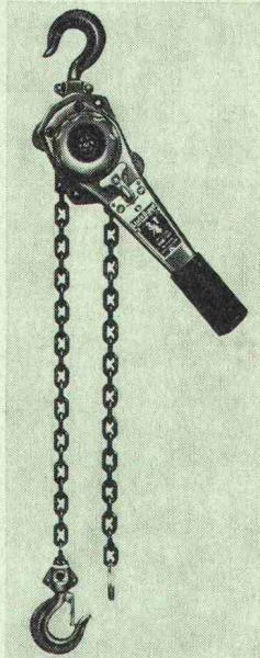
Ein neuartiger Kettenfreilauf erlaubt rasches Einrichten des Gerätes. Durch Drehen des Handrades wird eine straffe Vorspannung bewirkt. Mit dem Hebel kann im Umkreis von 360° frei gerätscht werden, was das Arbeiten bei ungünstigen Platzverhältnissen erleichtert. Das Gerät kann so überall zum Ziehen, Spannen, Heben, Senken, Verankern verwendet und in jeder Lage eingesetzt werden.
