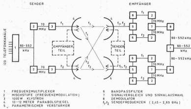
Bild 11. Blockschaltbild - Troposcatter Verbindung mit Vierfachübertragung
