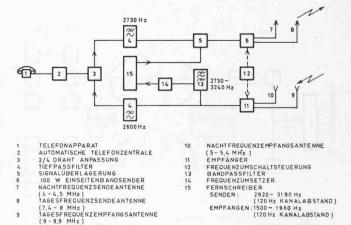
Bild 8. Blockschaltbild: Kurzwellen Sende- und Empfangsstation
