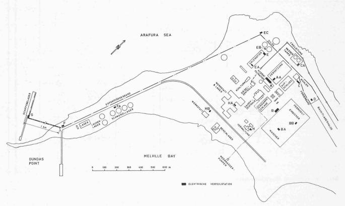
Bild 3. Werkverteilung: Lageplan, die Unterstationen sind mit Buchstaben bezeichnet
