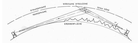
Bild 9. Troposcatter Funkverbindung; Prinzip
