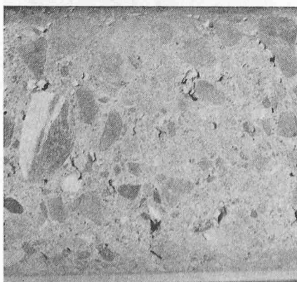
Bild 1. Beton PC 300, im üblichen Schüttverfahren eingebracht. Man beachte die vielen Lufteinschlüsse und Poren
