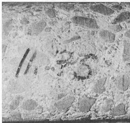
Bild 2. Beton-Bohrkern. Bindemittel und Feinanteile durch Spülwasser oberflächlich ausgewaschen
