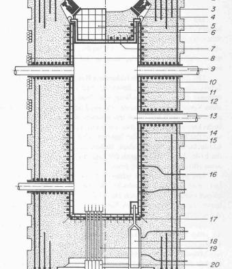
Bild 1 (rechts). Schnitt durch den neuen Spannbeton-Druckbehälter für Leichtwasserreaktoren
