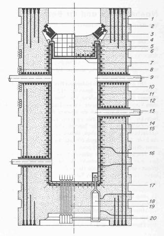
Bild 1 (rechts). Schnitt durch den neuen Spannbeton-Druckbehälter für Leichtwasserreaktoren
