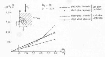
Bild 13. Durchmesseränderungen eines Bohrloches in Funktion des primären Spannungszustandes für elastisches und elastisch-plastisches Material
