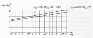
Bild 2. Darstellung der aus den Widerstandsgesetzen von H. Schlichting und Prandtl-Colebrook resultierenden Eponenten  $\alpha_p$  und  $\alpha_R$  für «hydraulisch glatte» Platten und Rohre bei turbulenter Strömung
