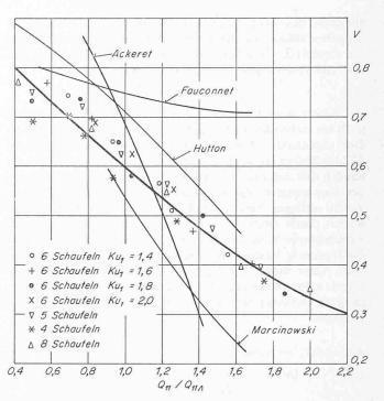
Bild 4. Verlauf der Verlustverteilungsziffer bei Kaplanturbinen nach Angaben verschiedener Autoren
