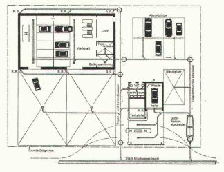
Einbaubeispiel eines Gross-Benzinabscheiders Unterlagen mit allen Berechnungsgrundlagen bei
