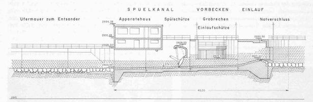
Bild 25. Schnitt 1:500 durch Einlauf und Spülkanal der Fassung Tamboraque
