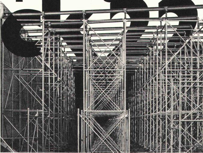
Das neue Spriessgerüst ck 22 dient zur Lastübertragung, insbesondere von Betonlasten. Das System besteht aus fachwerkartigen Rahmen, die seitenversetzt übereinander gestellt und mit Diagonalen zu einem Turm verbunden werden. Mit den schraubenlosen Verbindungen lassen sich sowohl Einzeltürme
