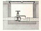
Rückstaudoppelverschluss TRIPLEX für durchgehende Leitungen
