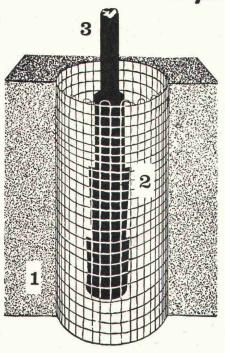
1 = Schnitt Beton 2 = Beton-Drahtkern 3 = Eisenstück, einzubetonieren
