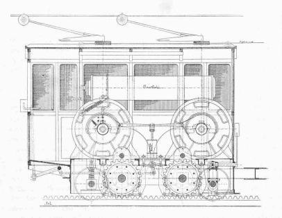
Links: Längenschnitt 1:50, Jungfraubahn, Elektrische Lokomotive
