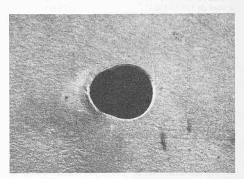
Bild 3. Charakteristisches Lochbild bei externer Lochleibungspressung
