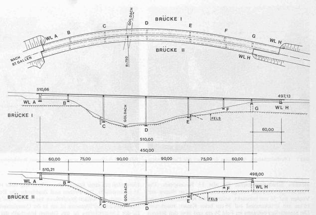
Bild 3. Grundriss und Längsschnitte des Goldach-Viaduktes, Massstab 1:4000
