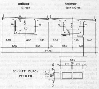
Bild 4. Brückenquerschnitt mit Schnitt durch einen Pfeiler
