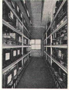
Paletten-Rollgestellanlage mit spritz-und strahlwassergeschützte 14 Doppel-Fahrgestellen. Tragkraft 60 t je Gestell. Einzel-Chassisantrieb mit direkt angeflanschtem Stirnrad-Bremsgetriebemotor, über Fussschalter steuerbar.
