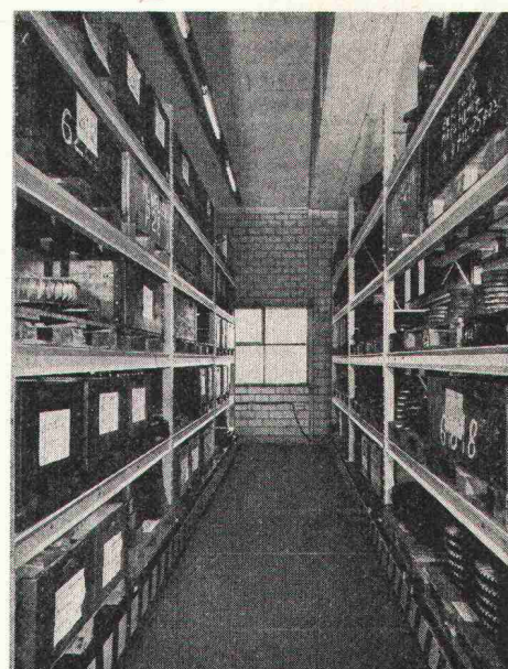
Paletten-Rollgestellanlage mit 14 Doppel-Fahrgestellen. Tragkraft 60 t je Gestell. Einzel-Chassis-antrieb mit direkt angeflanschem Stirnrad-Bremsgetriebemotor, über Fusschalter steuerbar.
