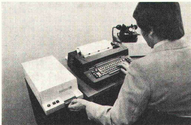
Das ist die Einrichtung, die Sie brauchen, um Computerleistung direkt am Arbeitsplatz zu erhalten: das Terminal IBM CMC (oder ein anderes Terminal), Modem und Telefon. Das Spezielle am Terminal IBM CMC ist, dass es sich zusätzlich als Magnetkartenschreibmaschine einsetzen lässt.
