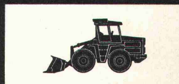
Radlader Europ L 1000 Motor: 120 SAE-PS Schaufeln: 1,1–1,8 m³ Gewicht: 7800 kg
