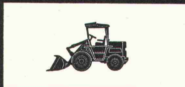
Radlader Europ L 500 Motor: 35 SAE-PS Schaufeln: 0,4–0,85 m³ Gewicht: 4350 kg
