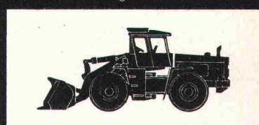
Radlader Europ KL 30 Motor: 240 SAE-PS Schaufeln: 2,5–4,8 m 3 Gewicht: 17200 kg
