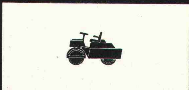
Vibrations-Tandemwalze VT L Statisches Gewicht: 2,0 t Arbeitsbreite: 1000 mm
