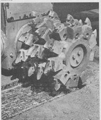
umweltfreundliche Maschine (kein Rauch) vielfältige Verwendung bei Strassenbelags-Reparaturarbeiten, beim Entfernen von Belag längs Randsteinen, bei Schächten, bei Fahrbahnübergängen – kurz dort, wo die herkömmlichen Abschäl- oder Abfräsmaschinen versagen oder der Belag mit Abbauhammer abgebaut werden müsste.
