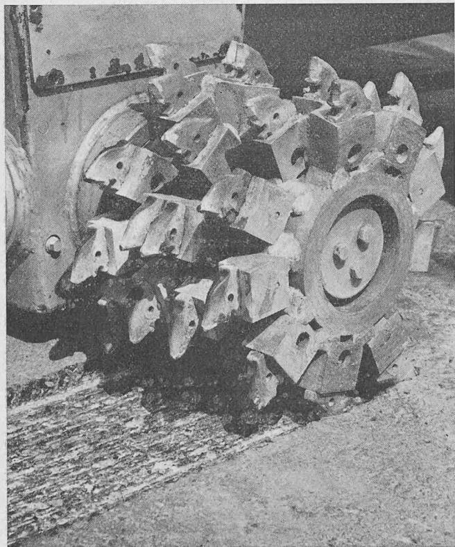
umweltfreundliche Maschine (kein Rauch) vielfältige Verwendung bei Strassenbelags-Reparaturarbeiten, beim Entfernen von Belag längs Randsteinen, bei Schächten, bei Fahrbahnübergängen – kurz dort, wo die herkömmlichen Abschäl- oder Abfräsmaschinen versagen oder der Belag mit Abbaumesser abgebaut werden müsste.
