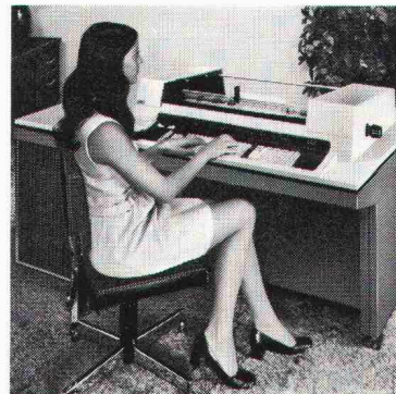
NCR 399 – die Vorzüge der tastaturorientierten Buchungsautomaten mit Magnetkonto und die hohen Geschwindigkeiten und Speicherkapazitäten des Computers in einer Anlage vereint.
