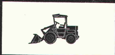
Radlader Europ L 500 Motor: 35 SAE-PS Schaufeln: 0,4–0,85 m 3 Gewicht: 4350 kg
