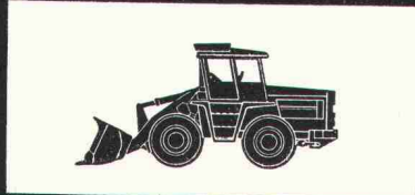
Radlader Europ L 1500 Motor: 139 SAE-PS Schaufeln: 1,3–2,5 m 3 Gewicht: 10200 kg
