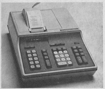
n-Fakultät, x% von y, prozentualer Unterschied, Summenbildung, Mittelwert und Standardabweichung, x², 10x, sowie Koordinaten-Umwandlung. Winkel können in Altgrad, Neugrad und im Bogenmass eingegeben und umgewandelt werden. Konstanten zur Umrechnung von cm in inches, kg in lbs, 1 in Gallons und umgekehrt, können aufgerufen werden.
