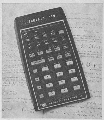
Neben der erhöhten Speicherkapazität ist der neue HP-45 der erste Taschenrechner, mit dem Koordinatenumwandlungen durchgeführt werden können und bei dem sich Umwandlungsfaktoren von metrischen in amerikanische Masse und umgekehrt, aufrufen lassen. Vierundzwanzig der fünfunddreissig Tasten lassen sich auf eine zweite Funktion umschalten. Winkel können in Altgrad, Neugrad und im Bogenmass eingegeben werden. Der HP-45 hat einen Rechenbereich von 10-99 bis 1099.
