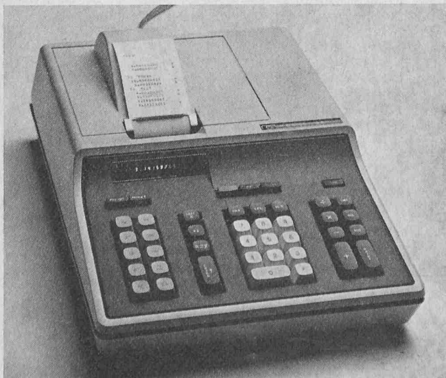
Bild 2. Tischrechner HP-46 mit Leuchtdioden-Anzeige und eingebautem Drucker
