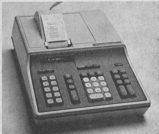
Bild 2. Tischrechner HP-46 mit Leuchtdioden-Anzeige und eingebautem Drucker
