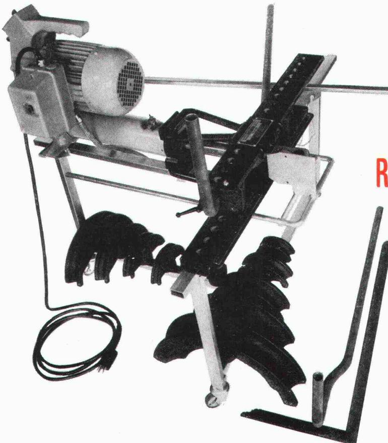
Die neue Ausführung des oberen, patentierten Gleitbügels ermöglicht das Biegen von **Bogen an Bogen**.
