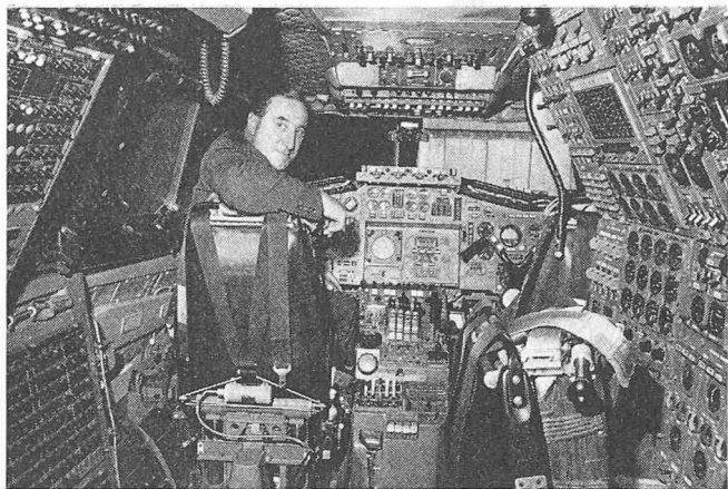
Blick in das Cockpit des britischen Concorde-Prototyps 002. Bei den Verserienmodellen wurde die Instrumentierung geändert und ergänzt durch eine vollautomatische Flugregelanlage. Am Pilotenplatz der BAC-Chefpilot Brian Trubshaw
