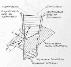
Bild 7. Schnitt durch «äquivalente Mittel-
