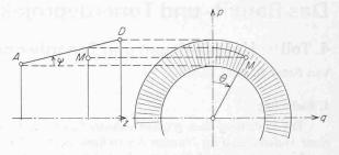
Bild 12. Bestimmung der zu den «Punktepaaren» gehörenden ebenen Schnitte
