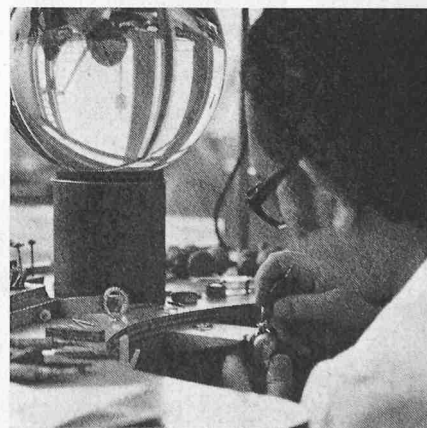
Juwelenfasser beim Fassen eines Brillanten
