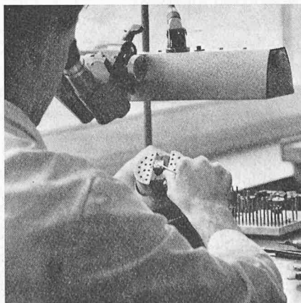
Graveur bei der Arbeit an einem handziseilierten Wappenring
