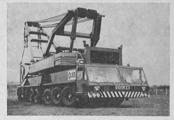
sammengeschweisst. Ein Sechspunkthebersystem, das ausfahrbare Kastenprofilstützen am hinteren Ende, ausfahrbare Mittelstützen mit Hebeschrauben und feste Vorderheber umfasst, bietet die nötige Stabilität für Schwenkung in einem Winkel von 360  $^{\circ}$  bei maximaler Belastung.
