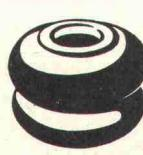
Antivibrationselemente für die schwingungs- und stoßdämpfende Lagerung; Gummifeder-Elemente für Schock- und Stoßisolierungen; Luftfeder-Elemente für Stoßbelastungen.
