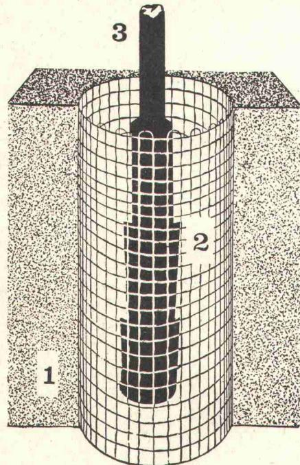
1 = Schnitt Beton    2 = Beton-Drahtkern    3 = Eisenstück,
