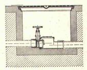
Rückstaudoppelverschluss TRIPLEX für durchgehende Leitungen
